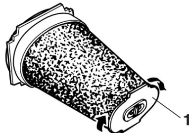
1. Placa de fijación del filtro de aire
