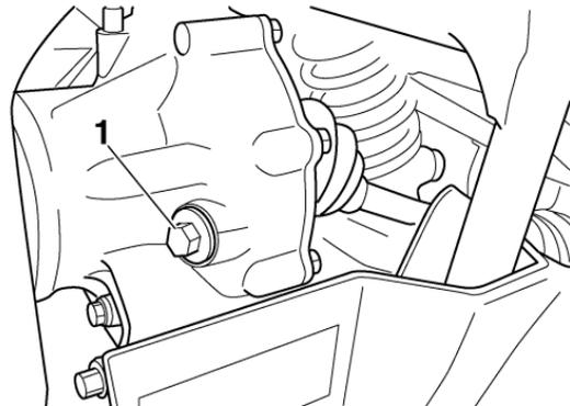
1. Bouchon de remplissage d'huile de couple conique arrière
