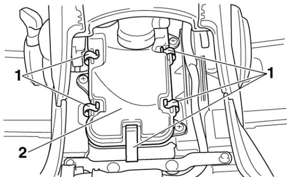
1. Attache du boîtier de filtre à air
