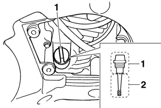
1. Bouchon de remplissage de l'huile moteur
