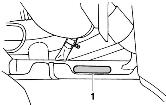
1. Numéro d'identification du véhicule (côté avant gauche)
