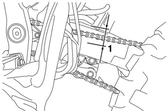
1. Tension de la chaîne de transmission
