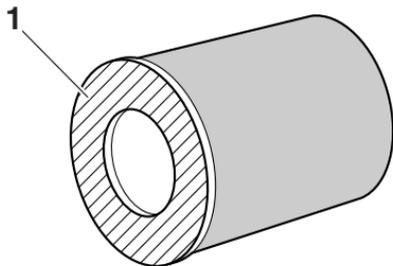
1. Siège de l'élément du filtre à air
