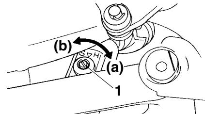
1. Vite di regolazione dello smorzamento in estensione
