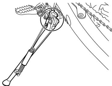
Prima di utilizzare il mezzo, controllare sempre il funzionamento del cavalletto laterale, e lubrificare, se necessario, il perno di guida del cavalletto laterale e le superfici di contatto metallo/metallo.
