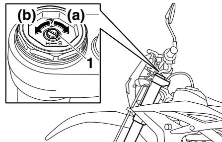
1. Vite di regolazione dello smorzamento in compressione
