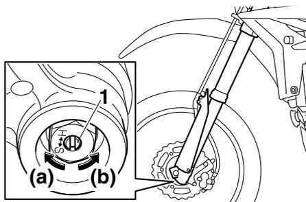
1. Vite di regolazione dello smorzamento in estensione
