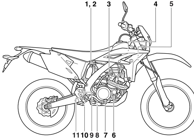
1. Vite di regolazione dello smorzamento in compressione dell'ammortizzatore (per smorzamento in compressione lento) (pagina 3-16)
