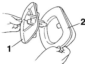
1. Telaio dell'elemento del filtro dell'aria
