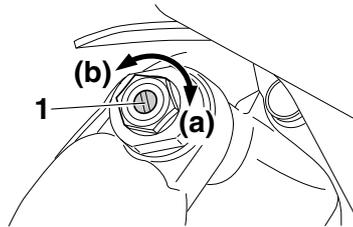
1. Vite di regolazione dello smorzamento in compressione (per smorzamento in compressione lento)
