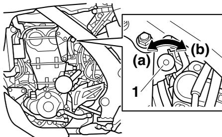
1. Pomello starter/vite di regolazione del minimo
