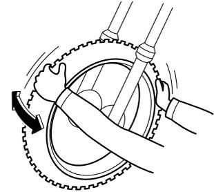
Si devono controllare i cuscinetti ruota anteriore e posteriore agli intervalli specificati nella tabella della manutenzione periodica e lubrificazione. Se c'è del gioco nel mozzo ruota, o se la ruota non gira agevolmente, fare controllare i cuscinetti ruote da un concessionario Yamaha.
