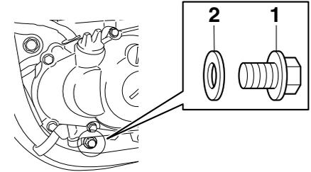
1. Bullone scarico olio motore (serbatoio olio)
