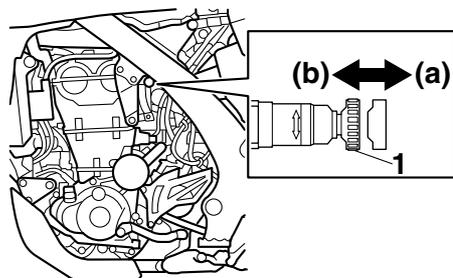
1. Pomello starter/vite di regolazione del minimo
