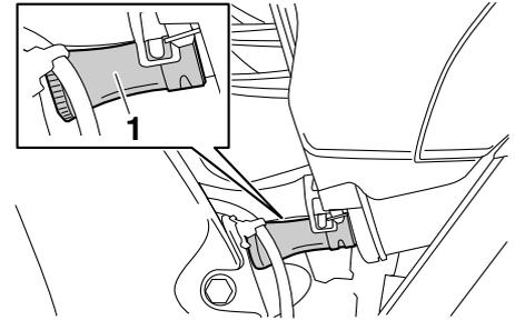
1. Tubo d'ispezione del filtro dell'aria
