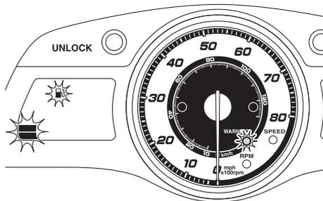
Se la spia di allarme livello carburante è attivata, rifornire il serbatoio del carburante al più presto possibile. (Vedere pagina 64 per informazioni sul rifornimento del serbatoio carburante.)
