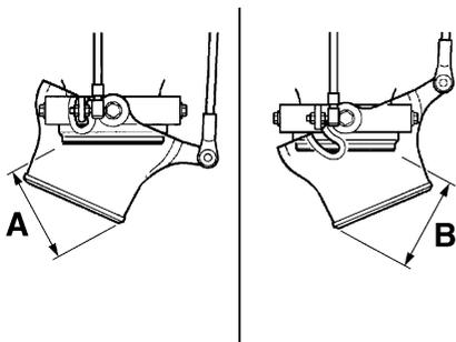
Differenza tra le posizioni di rotazione completa dell'ugello direzionale dell'idrogetto (distanze A e B): massimo 5 mm (0.20 in)
