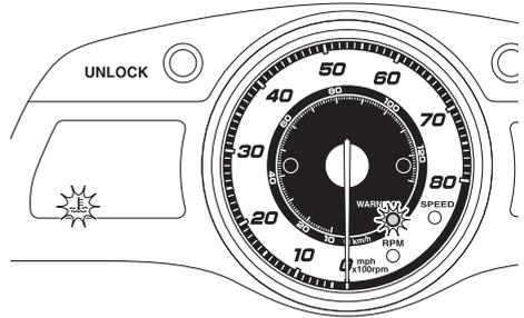
Se la spia di allarme pressione olio si attiva, ridurre immediatamente il regime motore, tornare a riva e controllare il livello dell'olio motore. (Vedere pagina 67 per informazioni sul controllo del livello dell'olio motore.) Se il livello dell'olio è insufficiente, far controllare la moto d'acqua da un concessionario Yamaha.
