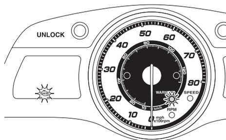
Se la spia di allarme controllo motore si attiva, ridurre immediatamente il regime motore, tornare a riva e fare controllare il motore da un concessionario Yamaha.
