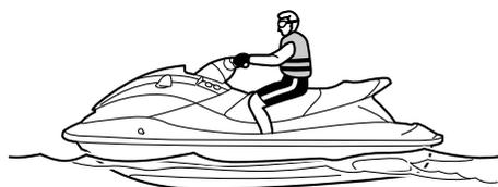
di 60 cm (2 ft) dal fondo della moto d'acqua. **ATTENZIONE:** Non fare mai funzionare il motore in acque con profondità inferiore a 60 cm (2 ft) dal fondo della moto d'acqua, poiché vi è il rischio di aspirare sassi o sabbia nella presa d'acqua dell'idrogetto, causando danni alla girante e il surriscaldamento del motore. [HCJ00473]
