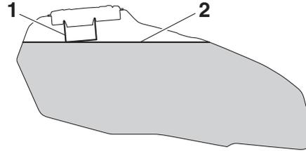
1. Tubo di rifornimento del serbatoio del carburante
