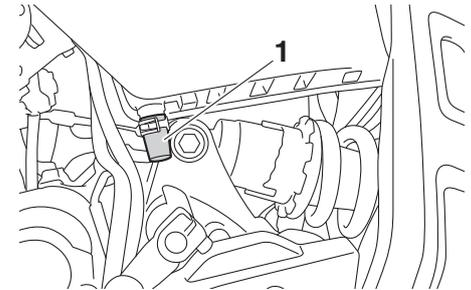
1. Tubo d'ispezione del filtro dell'aria
