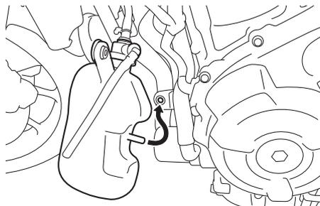
8. Togliere il bullone drenaggio liquido refrigerante e la rispettiva guarnizione per scaricare il liquido refrigerante dal sistema di raffreddamento.
