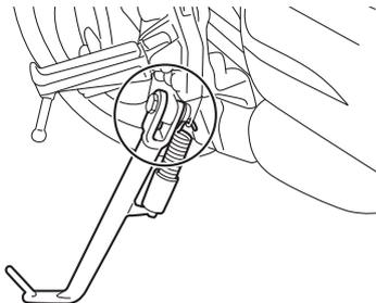
6 Prima di utilizzare il mezzo, controllare sempre il funzionamento del cavalletto laterale, e lubrificare, se necessario, il perno di guida del cavalletto laterale e le superfici di contatto metallo/metallo.
