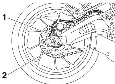
1. Sensore ruota posteriore
