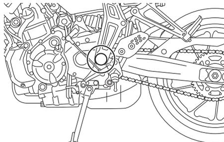
Si devono fare lubrificare i perni di guida del forcellone da un concessionario Yamaha agli intervalli specificati nella tabella di manutenzione e lubrificazione periodica.
