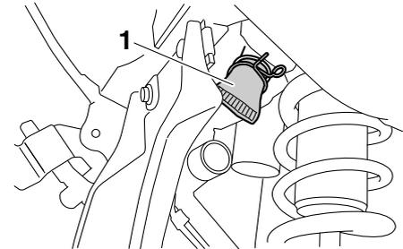
1. Tubo d'ispezione del filtro dell'aria
