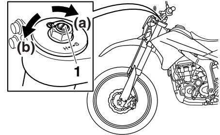
1. Vite di regolazione dello smorzamento in estensione
