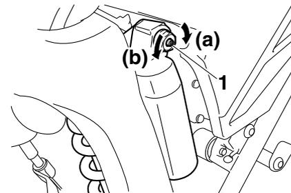
1. Vite di regolazione dello smorzamento in compressione
