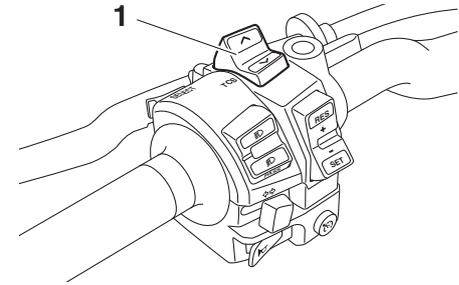
1. Interruttore del sistema di controllo della trazione "TCS"
