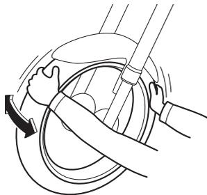
Si devono controllare i cuscinetti ruota anteriore e posteriore agli intervalli specificati nella tabella della manutenzione periodica e lubrificazione. Se c'è del gioco nel mozzo ruota, o se la ruota non gira agevolmente, fare controllare i cuscinetti ruote da un concessionario Yamaha.
