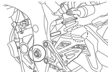
Si devono fare lubrificare i perni di guida del forcellone da un concessionario Yamaha agli intervalli specificati nella tabella di manutenzione e lubrificazione periodica.
