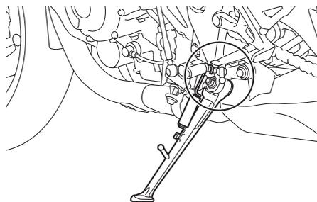
Prima di utilizzare il mezzo, controllare sempre il funzionamento del cavalletto laterale, e lubrificare, se necessario, il perno di guida del cavalletto laterale e le superfici di contatto metallo/metallo.
