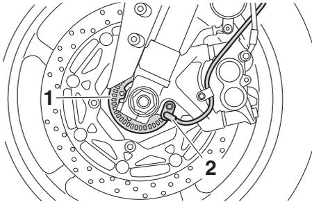
1. Rotore del sensore ruota anteriore
