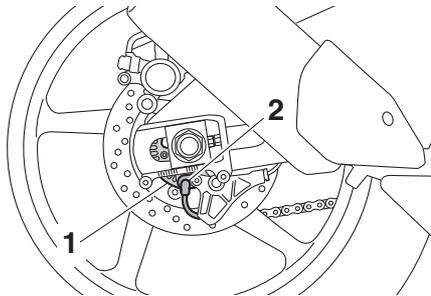
1. Rotore del sensore ruota posteriore
