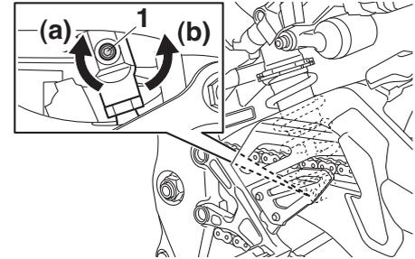
1. Vite di regolazione dello smorzamento in estensione
