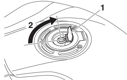
1. Coperchietto della serratura tappo serbatoio carburante
