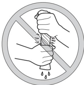
6. Nettoyer l'élément en mousse dans de l'eau savonneuse chaude afin d'éliminer le reste de dissolvant, puis rincer abondamment à l'eau claire.
