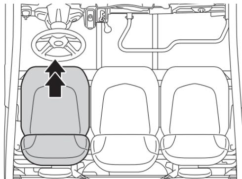
1. Déposer le coussin de siège du conducteur.
