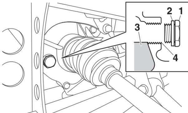
1. Boulon de remplissage de l'huile de différentiel
