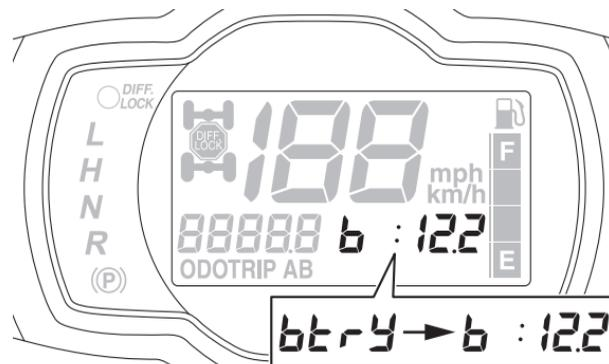
Cet afficheur indique la tension de la batterie. " $\text{b} \text{t} \text{r} \text{y}$ " s'affiche pendant une seconde lors de la sélection du mode d'affichage de la tension, puis " $\text{b} :$ " et la tension de la batterie s'affichent.
