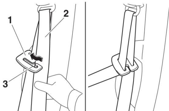
1. Dispositif de règlement de hauteur de ceinture de sécurité
