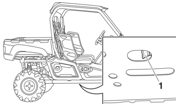
1. Tube de vidange du conduit d'admission d'air
