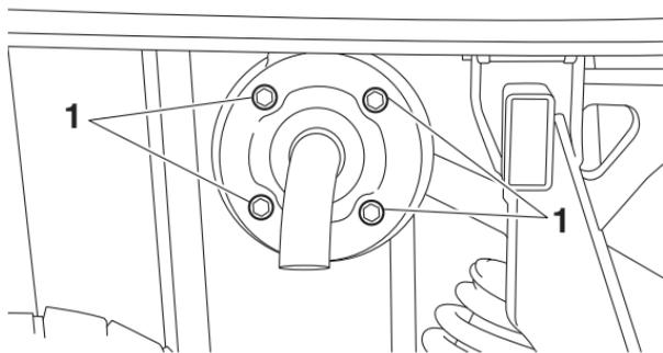
1. Vis de tube d'échappement arrière
