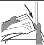
S'éloigner, tenir les mains et autrui à distance des points de contact lors de l'abaissement de la benne. Ne pas maintenir l'arceau de sécurité lors de la fermeture de la benne.
