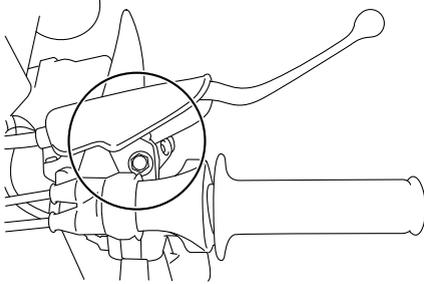
Contrôler le fonctionnement du levier de frein avant chaque départ et lubrifier l'articulation du levier quand nécessaire.
