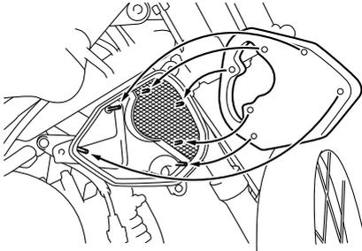
8. Remettre le couvercle du boîtier de filtre à air en place et le fixer à l'aide de ses vis.
