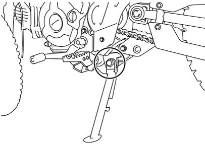
Contrôler le fonctionnement de la béquille latérale avant chaque départ et lubrifier son articulation et les points de contact des surfaces métalliques quand nécessaire.
