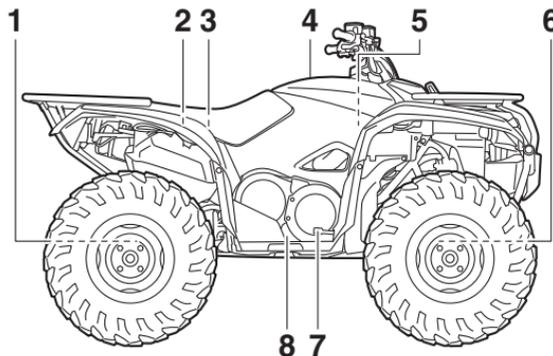
1. Aro de ajuste de la precarga del muelle del conjunto amortiguador trasero (YFM70KPXH / YFM70KPHH / YFM70KPSH / YFM70KPAH)
