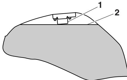
1. Tubo di rifornimento del serbatoio del carburante
