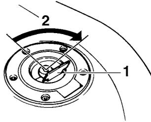
1. Coperchietto della serratura tappo serbatoio carburante
