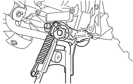
Contrôler le fonctionnement de la béquille centrale avant chaque départ et lubrifier les articulations et les points de contact des surfaces métalliques quand nécessaire.
