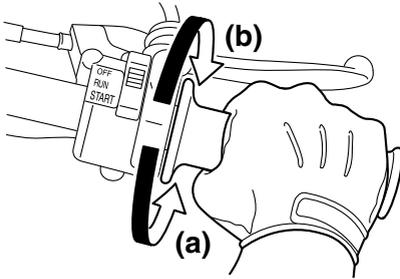
La vitesse se règle en donnant plus ou moins des gaz. Pour augmenter la vitesse, tourner la poignée des gaz dans le sens (a). Pour réduire la vitesse, tourner la poignée des gaz dans le sens (b).
