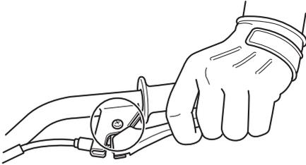
Lubrifier l'articulation des leviers de frein avant et arrière aux fréquences spécifiées dans le tableau des entretiens et graissages périodiques.
