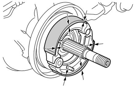
Si l'épaisseur d'une garniture d'une mâchoire de frein est inférieure à 1.5 mm (0.06 in), faire remplacer les mâchoires par un concessionnaire Yamaha.
