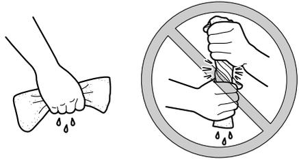
4. Enduire toute la surface de l'élément en mousse d'huile du type recommandé, puis éliminer l'excès d'huile en comprimant l'élément.
