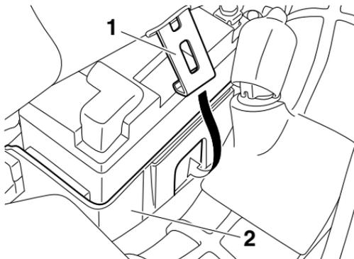
1. Placa de sujeción de la batería
