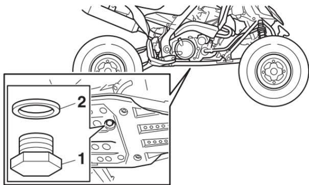
1. Perno de drenaje del aceite de motor del cárter
