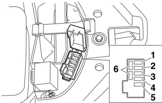
1. Fusible del sistema de inyección
