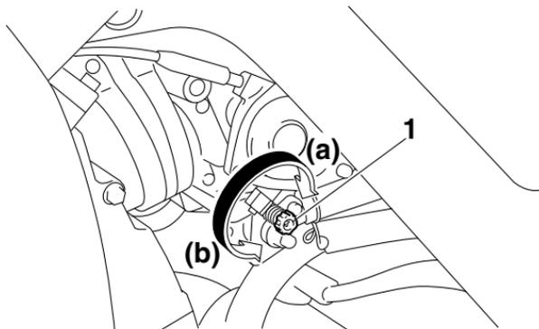
1. Tornillo de ajuste del acelerador
