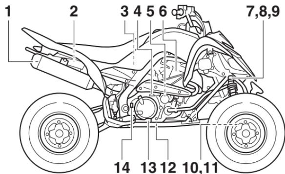
11. Tornillo de ajuste de la extensión del conjunto amortiguador delantero (YFM70RSSG)
