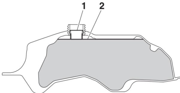
1. Tubo de llenado del depósito de gasolina
