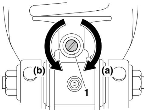
1. Tornillo de ajuste del hidráulico de extensión
