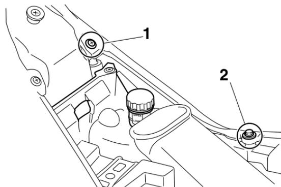
1. Tornillo de fijación rápida
