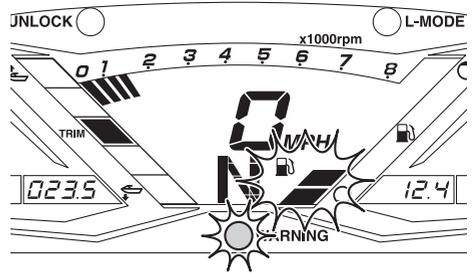
Se la spia di allarme livello carburante è attivata, rifornire il serbatoio del carburante al più presto possibile. (Vedere pagina 51 per informazioni sul rifornimento del serbatoio carburante.)
