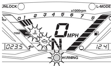
Se la spia di allarme pressione olio si attiva, ridurre immediatamente il regime motore, tornare a riva e controllare il livello dell'olio motore. (Vedere pagina 54 per informazioni sul controllo del livello dell'olio motore.) Se il livello dell'olio è insufficiente, far controllare la moto d'acqua da un concessionario Yamaha.
