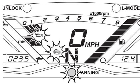
scaldamento del motore è attivata, il regime massimo del motore risulta limitato.
