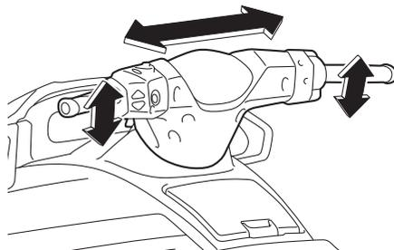
Virar totalmente o guidador para a esquerda e para a direita para verificar se a tubeira do jato se move quando o guidador é virado e se não há diferença entre as posições da tubeira
