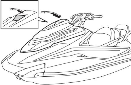
Para drenar água do compartimento de armazenamento na proa:
