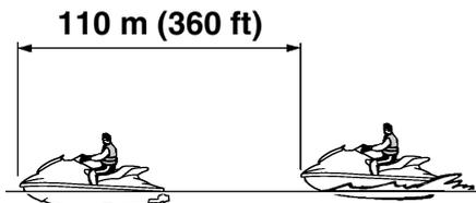
Se o comando RiDE for apertado para abrandar, a distância de paragem é aproximadamente 30% menor do que quando não é usado o comando RiDE. Porém, esta distância depende de diversos fatores, incluindo o peso bruto do veículo, o estado da superfície da água e a direção do vento.
