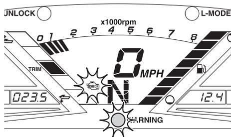
Se a luz avisadora de verificação do motor for ativada, reduzir imediatamente a velocidade do motor, voltar a terra e solicitar a verificação do motor a um Concessionário Yamaha.
