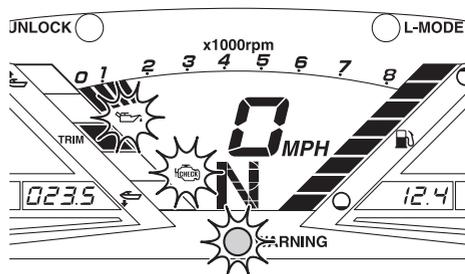
Se a luz avisadora da pressão do óleo for ativada, reduzir imediatamente a velocidade do motor, voltar a terra e verificar o nível do óleo do motor. (Ver as informações sobre a verificação do nível do óleo do motor na página 56.) Se o nível do óleo for suficiente, solicitar a um Concessionário Yamaha a verificação do veículo aquático.
