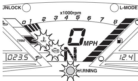
Se o avisador de sobreaquecimento do motor for ativado, reduzir imediatamente a velocidade do motor, voltar a terra e verificar se existe descarga de água pela saída piloto da água de refrigeração com o motor em funcionamento. Caso não haja descarga de água, desligar o motor e verificar se a tomada do jato está obstruída. (Consultar mais informações sobre a tomada do jato na página 100.)
