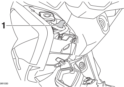
1. Tappo serbatoio liquido refrigerante
